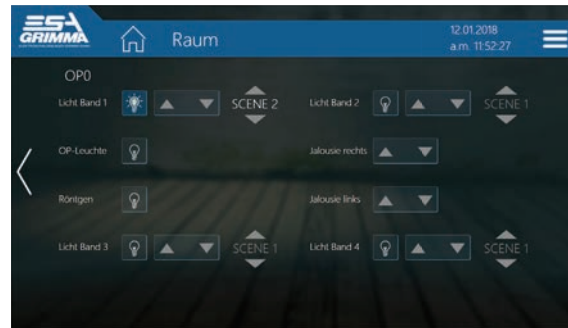
Raum – Beleuchtungs- und Jalousiesteuerung
