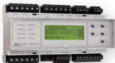
Многофункциональный контрольно-коммуникационный прибор UEI-710-V.5
