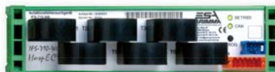
Прибор для поиска повреждений изоляции IFS-710-W6
