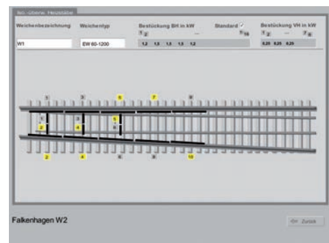
Visualisierung der Weichenheizung
