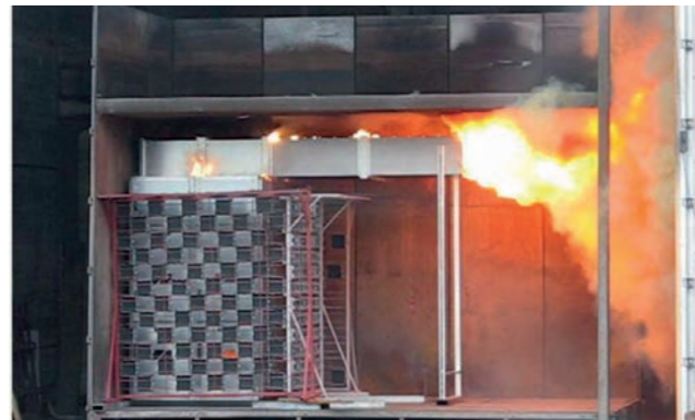
Störlichtbogenprüfung eines Mittelspannungsfeldes mit Druckentlastungskanal
